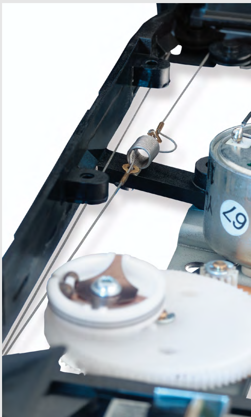
Ummanteltes Feinseil als Betätigungsseil im Einsatz Coated mini rope used as driving cable
